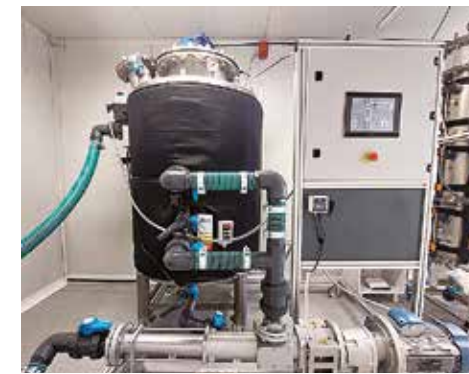
Αναερόβιος χωνευτής παραγωγής βιοαερίου πιλοτικής κλίμακας στον ΕΛΓΟ-ΔΗΜΗΤΡΑ
